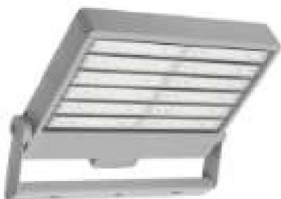
Luminaria tipo reflector formato rectangular, fabricada en aluminio, integrado por módulos LED marca NICHIA, ópticas independientes y driver electrónico inventronics. Ideal para espacios deportivos tipo estadio y super postes.
